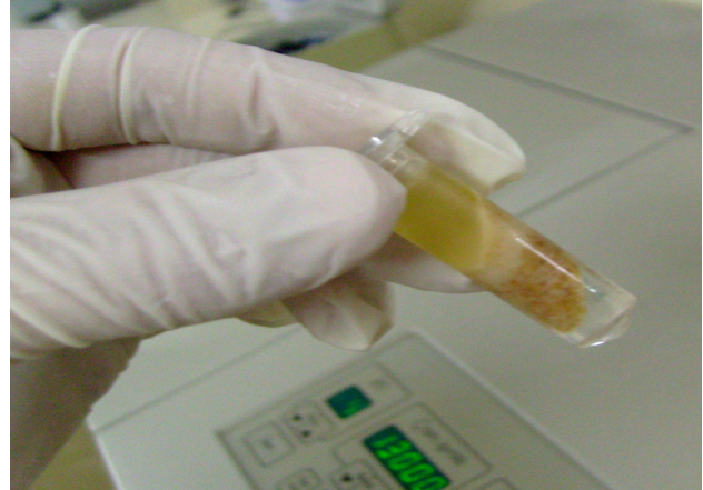
Fig. 4. Extração com solvente orgânico para separação da fase orgânica da fase aquosa.
